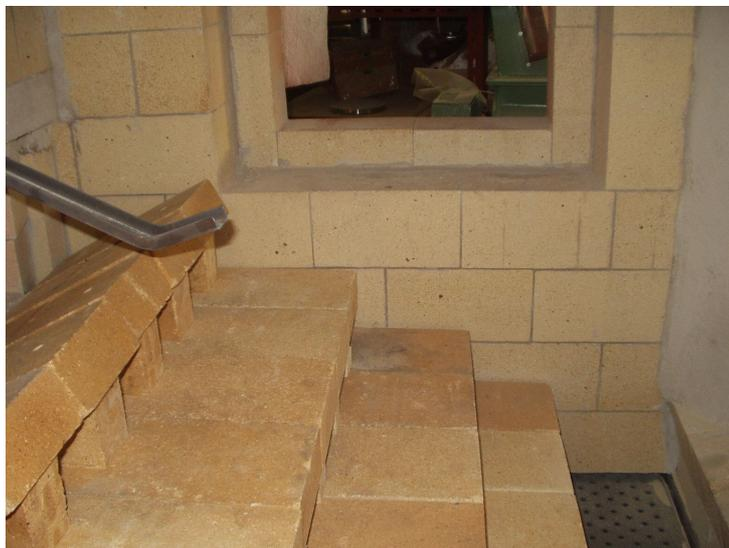
Nad podlahou komory je uložen šikmý schodovitý rošt. Jeho konstrukce a tvar jsou tvořeny speciálními keramickými tvarovkami, uloženými na nosné konstrukci, jejíž podstatou jsou vodu protékané horizontální trávce. To dává roštu perfektní stabilitu a tepelnou odolnost. Systém štěrbin, umístěných v čele každého stupně roštu umožňuje distribuci přehřátého vzduchu pro zplyňování. Zplyňovací vzduch je zónově regulován klapkami umístěnými v prostoru pod roštem.
