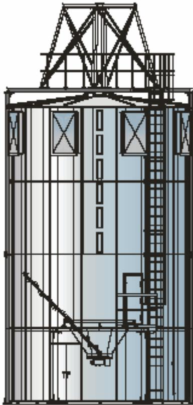
Silo slouží k uložení střednědobé a dlouhodobé spotřeby paliva před kotlem na piliny, hobliny, jemné štěrky, pelety, atp.
